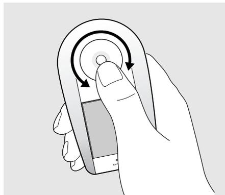
Die Bedienung des Telefons erfolgt mit Hilfe der Menüwählscheibe und des Touchscreens. Halten Sie das Telefon und drehen Sie die Menüwählscheibe, um den Touchscreen zu verwenden.
